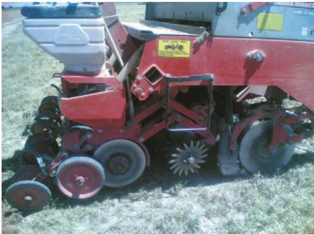
Figura 37. La colocación del barredor en la Semeato SP06 es imprescindible en regadío
