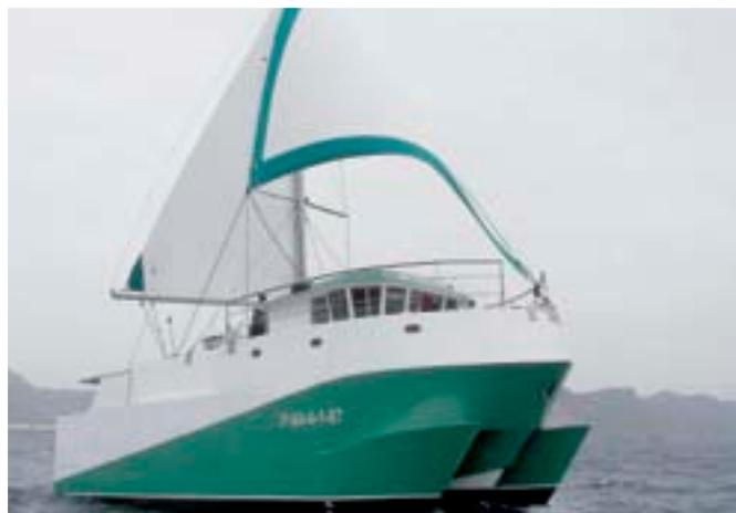
Buque de pesca con propulsión auxiliar mediante velas convencionales. Cortesía de Astilleros Mercurio Plastics, S.L. ([www.mercurioplastics.com](http://www.mercurioplastics.com))
