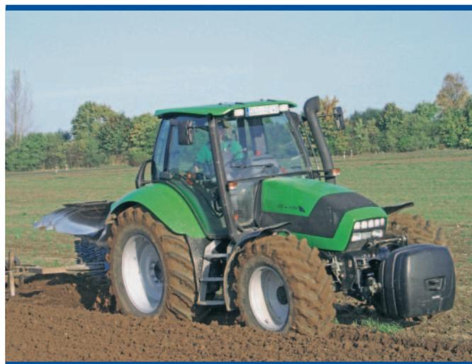
Para lograr un ahorro considerable de combustible en los trabajos pesados, se utilizará siempre la tracción a las cuatro ruedas. El ahorro de utilizar tracción a las cuatro ruedas comparado con la tracción a las dos ruedas es superior al 20%.
