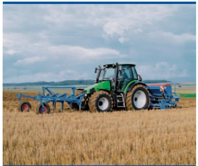
Para realizar menor número de pasadas con tractores de gran potencia, en la preparación del terreno o en la siembra, es aconsejable equiparlo con enganche y toma de fuerza delantera. Para un mejor desarrollo del trabajo y de la seguridad el elevador hidráulico será potente y flexible, con un fiable control de posición.
