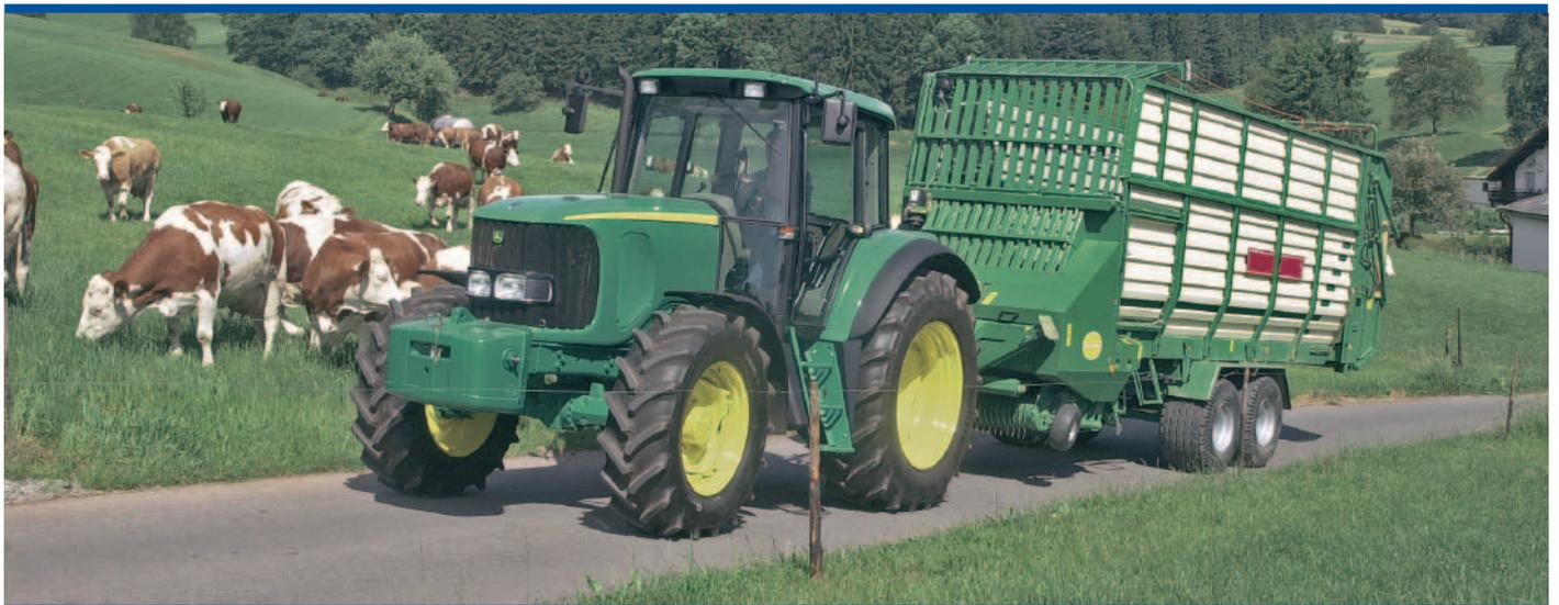
En todos los trabajos y principalmente en el transporte, los neumáticos deben ser controlados y responder a las características de carga según la velocidad máxima de circulación en camino y carretera. Es importante que las cubiertas, en su banda central, tengan continuidad de goma para reducir las vibraciones al desplazarse por carretera.
