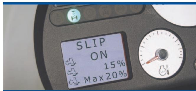
El nivel de patinamiento se puede comprobar directamente con un dispositivo de medición del mismo incorporado en las funciones específicas del tractor (si dispone del mismo), con la medición en campo (\*), o se puede intuir por la huella del tractor sobre el terreno.
