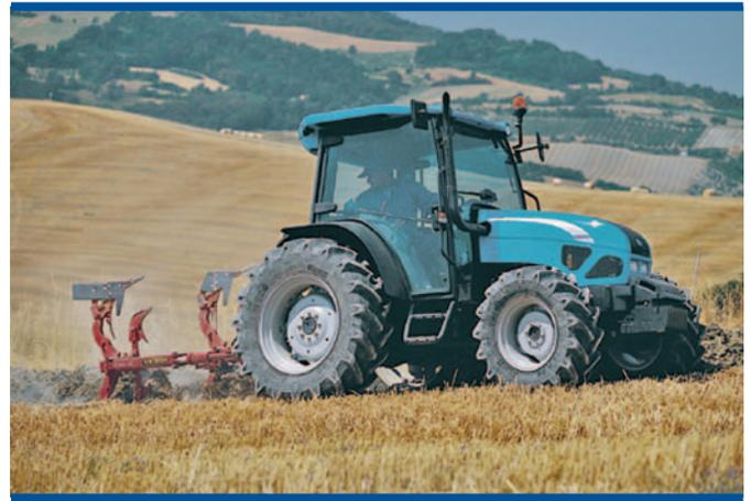
Para los trabajos de tracción es muy importante tener una *amplia gama de velocidades* y bien equilibradas, sobre todo entre 3 y 14 km/h, de forma que permita un aumento progresivo de la velocidad, habiendo una diferencia máxima entre ellas del 14%. Los cambios automáticos de velocidades permiten una mejor utilización de la potencia.
