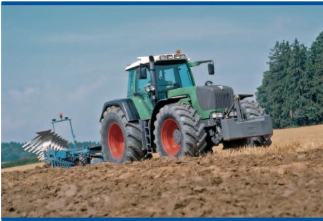
Normalmente, para este tipo de trabajos es necesaria la *tracción a las cuatro ruedas*. Es preciso fijarse también en el reparto del peso entre el eje delantero y trasero. En un tractor con tracción a las cuatro ruedas el reparto del peso está entre 30/70 ó 40/60, mientras que en uno con las cuatro ruedas iguales es de 50/50.
