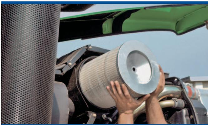
Por tanto, deberemos facilitar al máximo el paso del aire para tener un óptimo aprovechamiento del gasóleo, dotando al motor con un sistema de filtrado eficaz.
