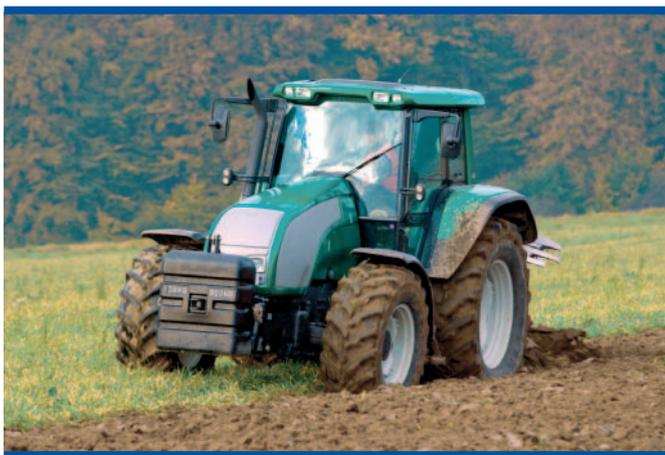
El lastrado del tractor se utiliza para evitar en parte el patinamiento y poder realizar labores diferentes de tracción. Consiste en añadir peso al tractor para equilibrarlo y evitar el patinamiento y puede hacerse con contrapesos delanteros, traseros, en los discos de la rueda o
