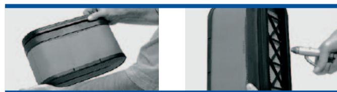
La limpieza con aire a presión la realizan más del 95% de los agricultores. El filtro se limpiará dirigiendo el aire desde el interior hacia el exterior, o sea, en sentido contrario de circulación del aire cuando el filtro está montado. No se sobrepasará una presión de aire de 7 kg/cm<sup>2</sup>.
