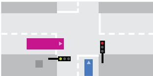
2º El sistema cierra los movimientos transversales y se abre el semáforo en el sentido en que circula el bus.
