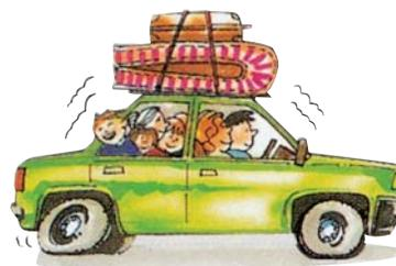
Una mala distribución de la carga puede ofrecer mayor resistencia al aire y mayor inestabilidad provocada por la disminución de adherencia del eje delantero.
