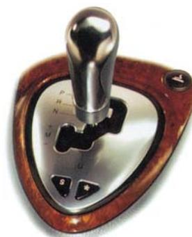
Las cajas de cambios automáticas eligen la relación de marcha adecuada sin intervención del conductor, en función de las revoluciones del motor y de la posición del acelerador.
