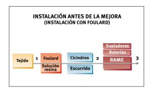
Quinta fase: En su forma final, el tejido pasa por los cilindros de presión que ayudan a su adhesión se introduce en la Rame de 7 campos con dos baterías de aceite por campo, para la correcta reacción de reticulación de los productos impregnados.
