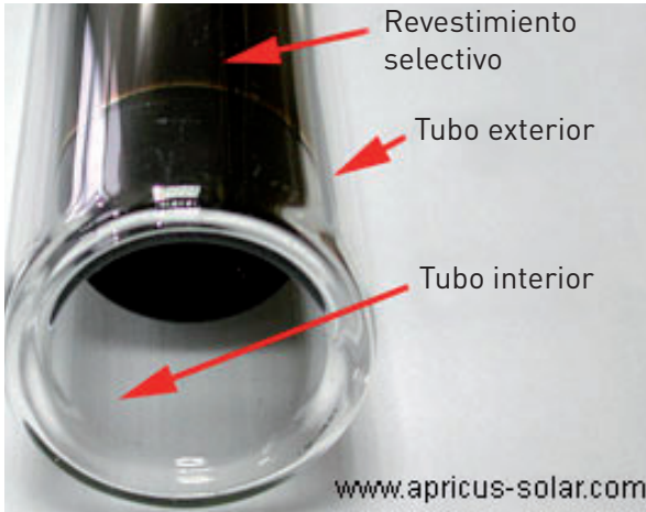
Figura 25. Tipos colectores de flujo directo: tubos de vacío vidrio-vidrio (glass-glass pipes)
