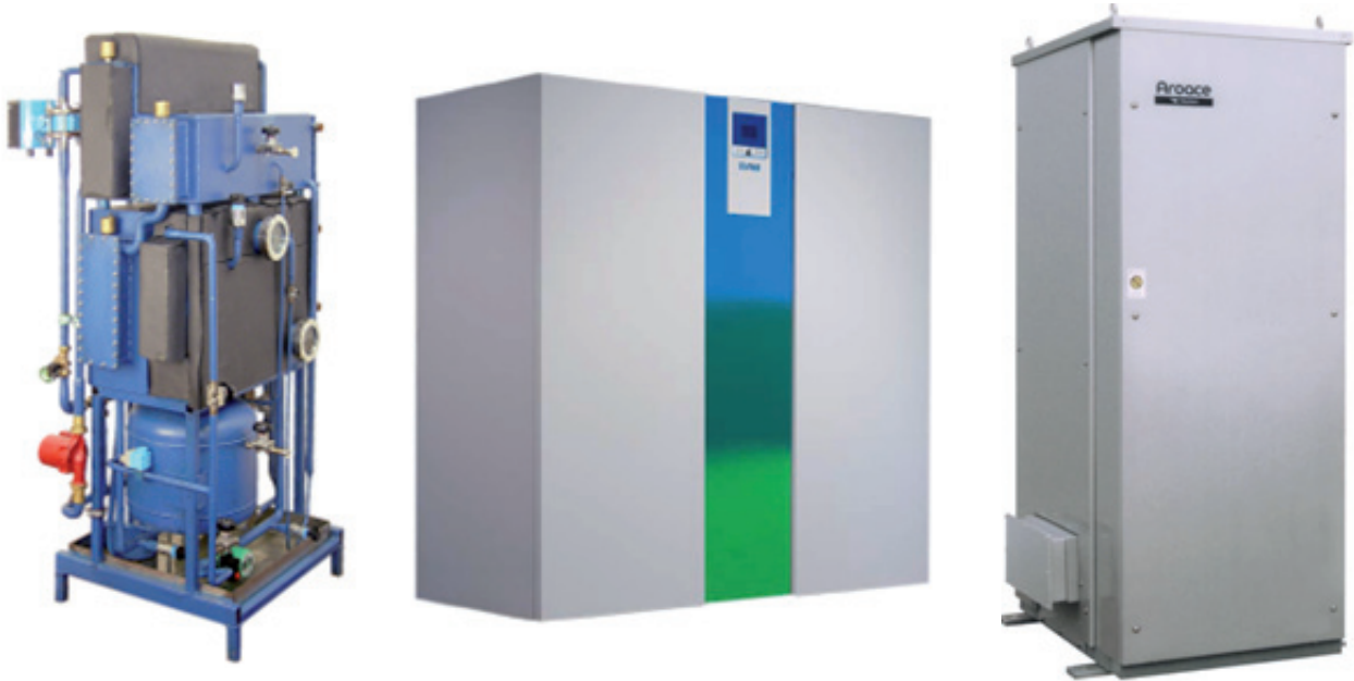
Figura 5. Ejemplos de pequeñas enfriadoras que usan agua como refrigerante y bromuro de litio como fluido de absorción: Sonnenklima 10 kW (izquierda), EAW-Schucco-15 kW (centro), Yazaki-17 kW (derecha)
