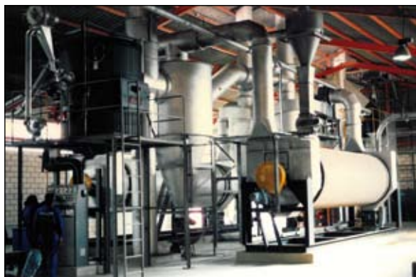
Figura 4.10: Secaderos rotativos con calor procedente de la biomasa.
