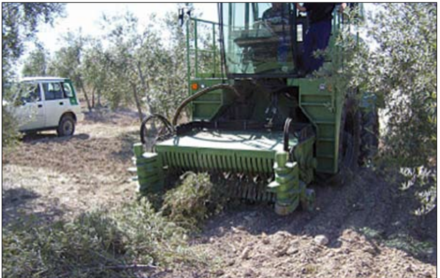
Figura 7: Sistema autopropulsado de hilerado y triturado Valoriza.
