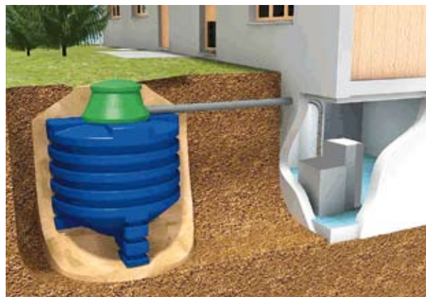
Figura 20: Depósito subterráneo para pélets
