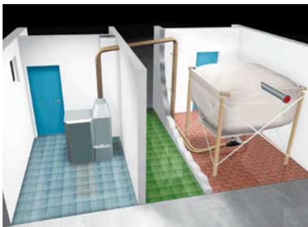
Figura 18: Silo flexible con sistema de alimentación neumática
