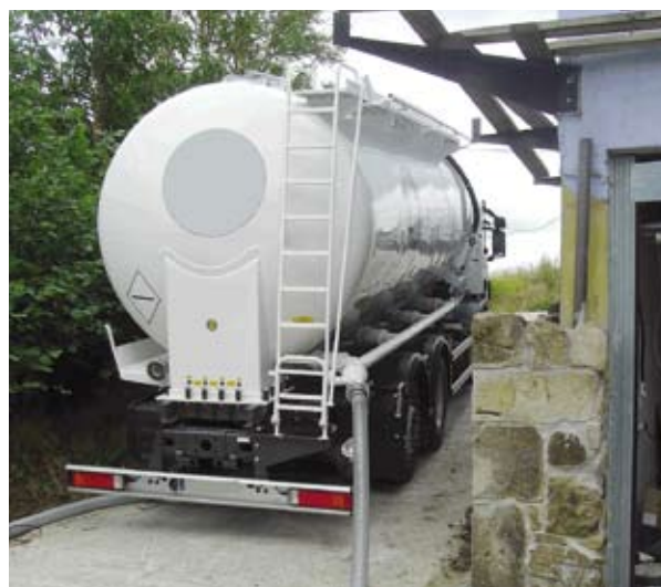
Figura 12: Recarga de silo mediante camión cisterna neumático
