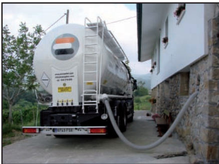
Sistema de alimentación de pelets a silo textil desde camión cisterna por sistema neumático. Centro de Agroturismo. Vizcaya.
