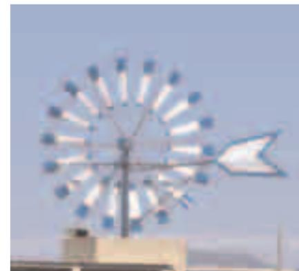
Las instalaciones de molinos multipala suelen emplearse en explotaciones agropecuarias aisladas cuyas necesidades de agua no sean elevadas, ya que su limitada potencia impide su aplicación con caudales grandes o a mucha profundidad. Un molino de 5 m de diámetro, especialmente indicado para captar caudales medios, a 7,5 m/s es capaz de impulsar 8.000 litros de agua por hora desde una profundidad de 50 metros.
