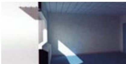
La ventana con voladizo es suficiente en posiciones cenitales del sol, pero en posiciones más bajas permite aún demasiado contraste
