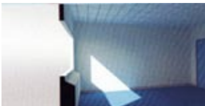
La ventana sin protección de la luz solar directa crea demasiado contraste en el interior de la sala
