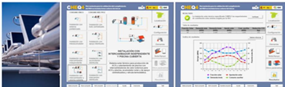
**CHEQ4** permite definir una amplia variedad de instalaciones solares introduciendo un mínimo de parámetros del proyecto asociados a cada configuración del sistema, y, de esta manera, obtener la **cobertura solar** que ese sistema proporciona sobre la demanda de energía para **ACS y piscina del edificio**.
